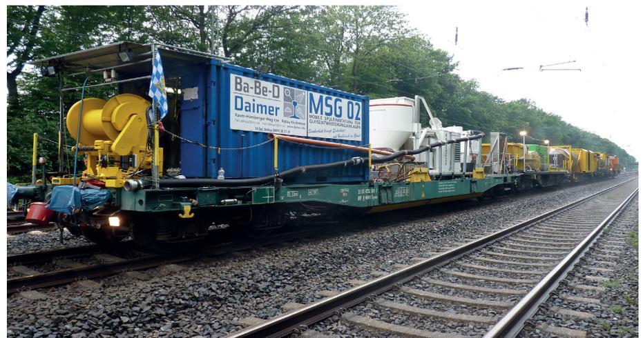
Abb. 2: Die gleisgebundene, mobile Spüleinheit für Gleisentwässerungsanlagen
