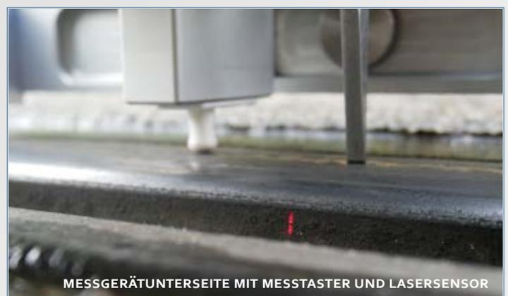
MESSGERÄTUNTERSEITE MIT MESSTASTER UND LASERSENSOR
