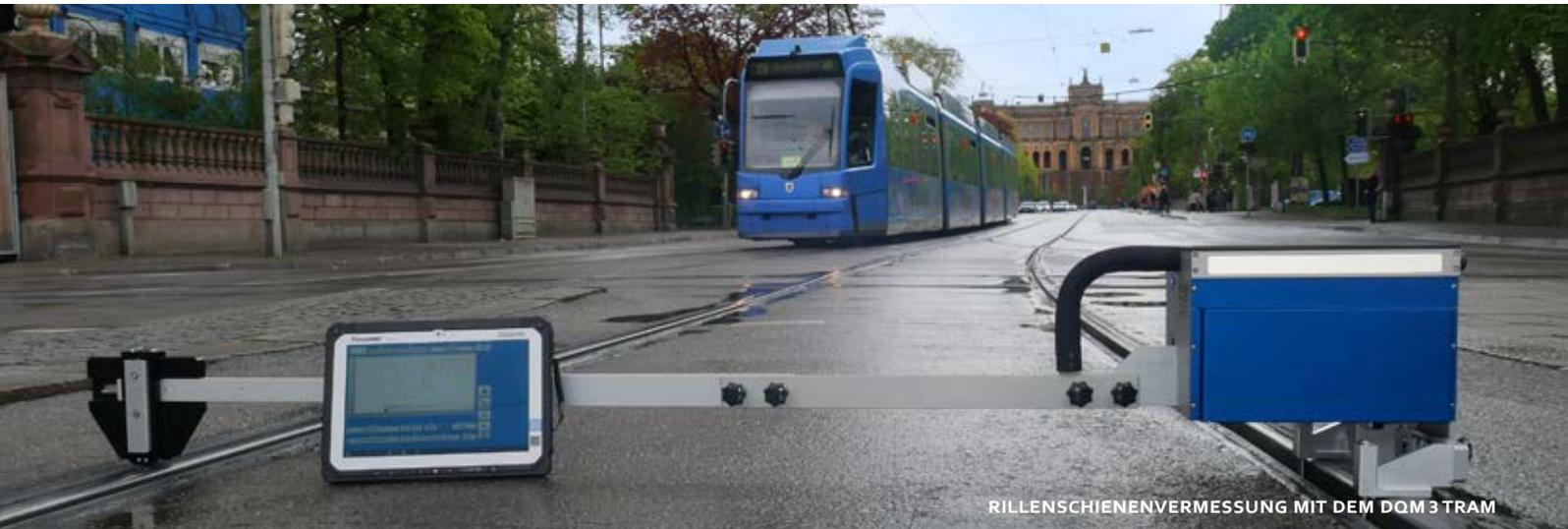
RILLENSCHIENENVERMESSUNG MIT DEM DQM3 TRAM
